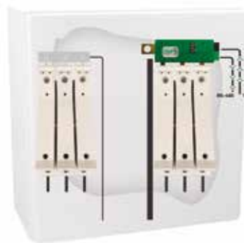
Ejemplo de instalación del CcM3 Solar 30 A en un cuadro de embarrado de seguidores con 3 series
