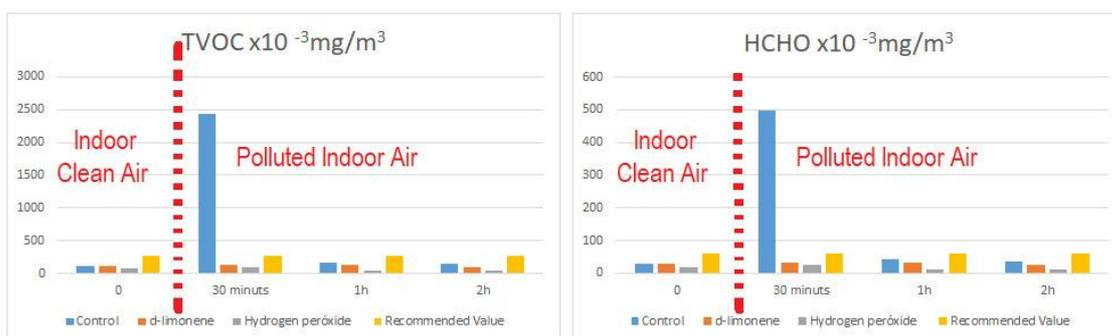
Figura 1. Medidas sobre la calidad del aire antes y después de contaminar la sala con la combustión de una varilla de incienso, comparación de la seguridad y la eficacia de Wellis en la eliminación de VOC's y formaldehído con cartucho de peróxido de hidrógeno y d-limoneno.
